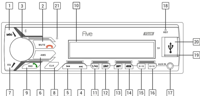
1. **MOD** кнопка включения/выключения устройства, выбора режимов ресивера.
